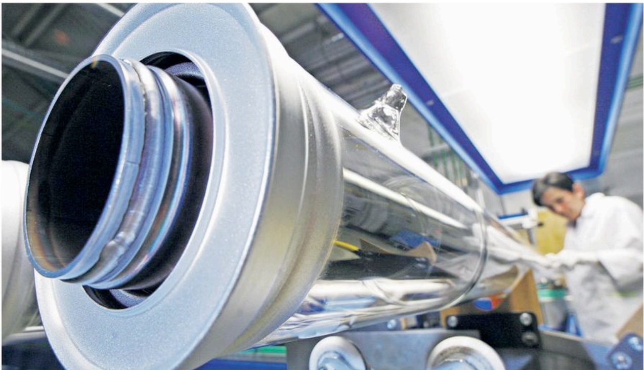
Receiver-Fertigung bei Schott: Die Bauteile sind ein wichtiger Bestandteil solarthermischer Kraftwerke. Sie übertragen Wärme auf die Turbinen.
